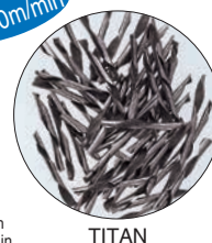
Material:TITAN V=75m/min. f=0.18mm/tooth S=1500r/min F=1700mm/min.
