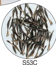
Material:S53C V=500m/min. f=0.25mm/tooth S=10000r/min F=10000mm/min.
