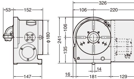
Powerful Clamping Torque : 303Nm
