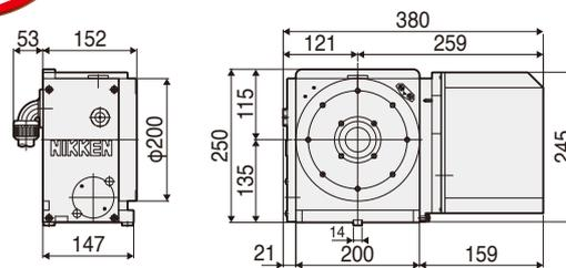
Powerful Clamping Torque : 900Nm
