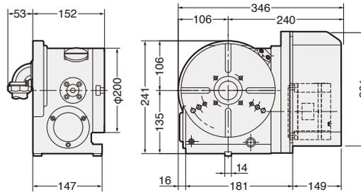
Powerful Clamping Torque : 303Nm
